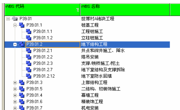
图 13 世博村 A 地块项目 WBS 结构图
